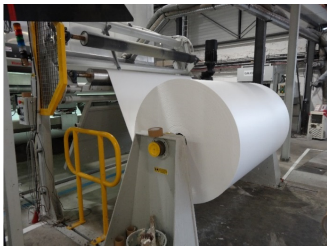
車載用バッテリーセパレータの原紙であるガラス繊維シート
