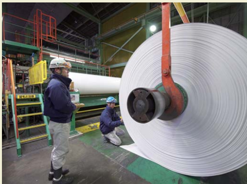
最終工程「リール」。幅3m、重さ15tの白板紙
