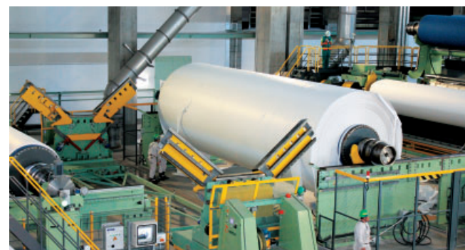
新潟9号抄紙機リール/No. 9 papermaking machine reel
