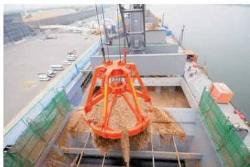
チップ船からの荷揚げ作業 Discharging operation at the port
