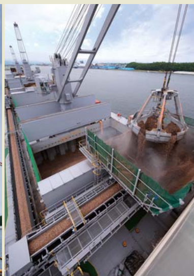
チップ船からの荷卸し作業
