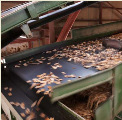
水平振動スクリーンによる製紙用チップの選別
