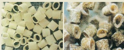
バイオ槽に投入前のハイカム 微生物が付着したハイカム
