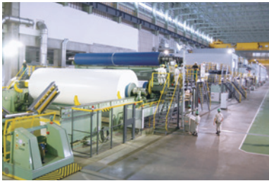
新潟工場の9号抄紙機では幅10m、長さ180kmのロール紙を、全長223mにおよぶマシン1台で原紙の抄造から塗工まで一貫して生産
