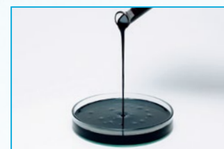
黒液：パルプ原料であるチップの樹脂分などからなるバイオマス燃料
