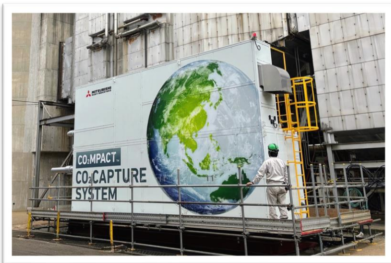
小型CO 2 分離回収装置(CO 2 MPACT™モバイル、三菱重工業(株))
