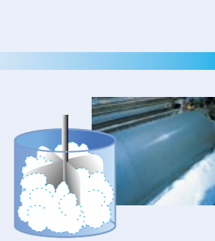
漂白・洗浄 漂白と洗浄でパルプ原料を更にきれいにし、高品質な古紙パルプができます。
