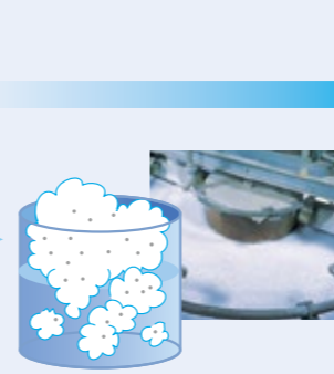
脱墨 (インクの除去) フローテーションで、パルプ原料液の中に含まれているインクを泡に付着させて取り除きます。
