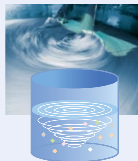
離解 洗濯機に似た「パルパー」と呼ばれる機械の中で古紙原料に水を加え、かき混ぜながらほぐしていきます。このときにビニールひもなどの粗大異物も取り除きます。
