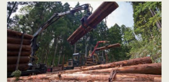
原木専用のクレーンを装着した「グラップルクレーントラック」。積み込み作業のスピードアップと木材の輸送コスト削減に役立つ。
