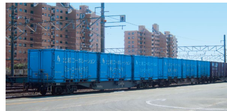
20ftコンテナの導入により、巻取製品の積み込みが可能になり輸送効率が上昇しました。
